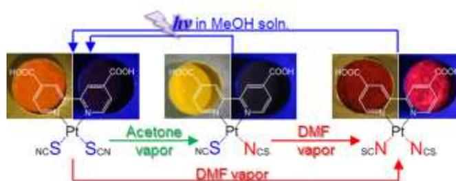
図1.  $[\text{Pt}(\text{SCN})_2(\text{H}_2\text{dcbpy})]$ の蒸気や光による選択的結合異性化に基づくクロミック挙動.
